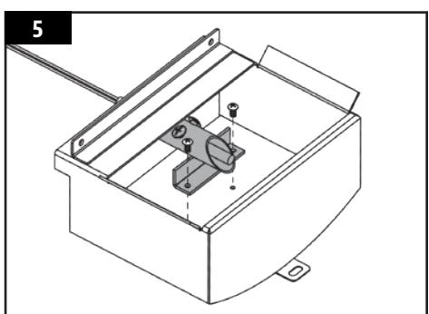
**IMPORTANT :** Les trous pour les deux vis doivent être auto-taraudées, car ils ne sont pas préfiletés. Le cas échéant, utilisez soigneusement une perceuse pour commencer, puis terminez le serrage à la main à l'aide d'un tournevis.
