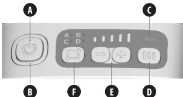
**A/STRÖM** ⚡ – Slå på/av massageenheten genom att trycka på strömbrytaren. Ringen runt strömknappen lyser för att indikera att enheten är på.
