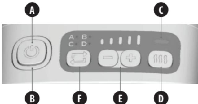
**A / VIRTÄ** ⏹ – Kytke/katkaise hierontalaitteen virta painamalla virtapainiketta. Virtapainikkeen ympärillä oleva rengas sytyy merkiksi siitä, että laite on päällä.
