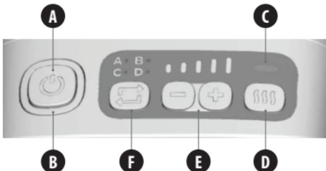
**A / ZASILANIE ⚡** – Naciśnij przycisk zasilania, aby włączyć/wyłączyć masażer. Obwódka wokół przycisku zasilania podświetla się, wskazując, że urządzenie jest włączone.
