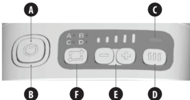
**A / EIN/AUS-TASTE** – Zum Ein- und Ausschalten Taste jeweils einmal drücken. Leuchtender Ring um Ein-/Austaste zeigt an, dass das Gerät eingeschaltet ist.
