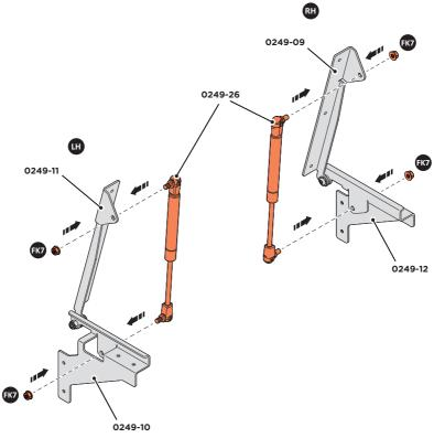
ROTATE BOX FRAME TO IT'S UPRIGHT POSITION. SECURE GAS STRUT & LID HINGE ASSEMBLIES TO PANELS & FRAME AS SHOWN.
