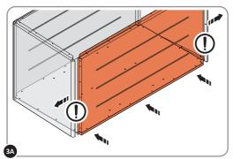
NOTE: SLIGHT OUTWARD ADJUSTMENT OF SIDE PANELS REQUIRED. LOCATE FRONT PANEL AND CAREFULLY POSITION BETWEEN SIDE PANELS. THE BOTTOM FRONT PANEL SLIDES UNDERNEATH FLOOR PANEL.
