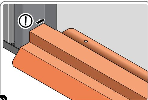
**6A** LOCATE DOOR STRIP 0205-11 OR 0205-73 AS SHOWN. **IMPORTANT:** ENSURE DOOR STRIP IS PUSHED AGAINST DOOR POST RETURN.
