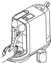
**Lorsque la mousse de lait est terminée**, soulevez la buse vapeur et essuyez-la avec un chiffon propre et humide.
