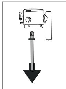
3. Ruotare il tubo erogazione latte in posizione perpendicolare e tirare fino ad estrarlo;
