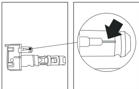
6. Verificare che il canalino aria (nell'ingrandimento) sia pulito;
