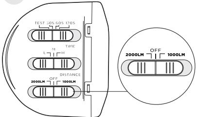
Antes de usar su lámpara solar con sensor de movimiento, el panel solar necesita estar conectado a la lámpara durante un período de tres días. Esta carga inicial debe realizarse en la posición de OFF (Apagado). Después del tercer día, las pilas incluidas estarán completamente cargadas y su lámpara solar con sensor de movimiento estará lista para funcionar.
