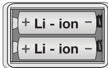
Vos piles sont installées dans le compartiment des piles à l'arrière du boîtier de la lampe. Placez le commutateur à la position OFF/ARRÊT avant d'ouvrir le compartiment des piles. Retirez les quatre vis pour accéder aux piles.
