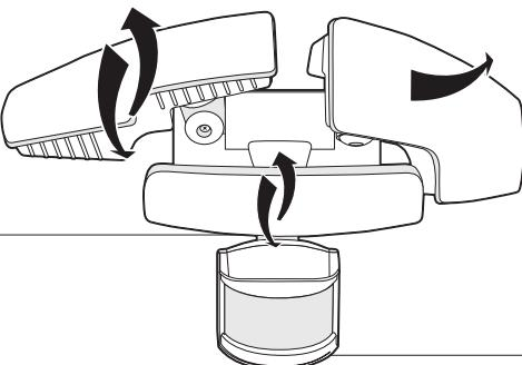
Lorsque votre lampe à détecteur de mouvement est installée, les têtes d'éclairage latérales peuvent être ajustées indépendamment pour offrir une couverture lumineuse optimale.
