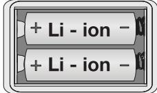
Las pilas se encuentran en el compartimento posterior de la lámpara. Ajuste el interruptor en la posición de apagado (OFF) antes de abrir el compartimento. Quite los cuatro tornillos para retirar las pilas.
