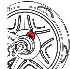
**Waarschuwing!** De freewheelfunctie kan alleen met de ouderhandgreep (duwstang) worden gebruikt.
